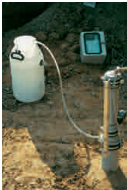
Abbildung 9: Versuchsanordnung nach dem Open-End-Test. (Fotos: Verfasser)
